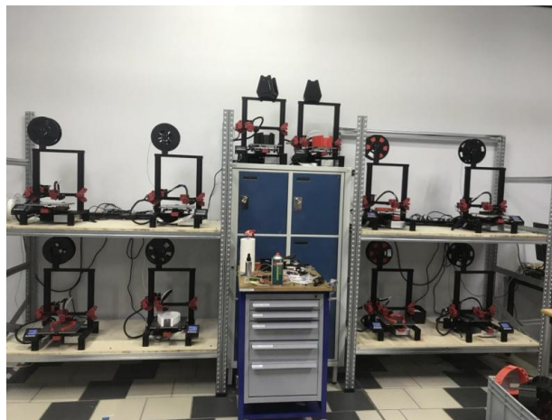
Dans l'atelier plasturgie du lycée, une quinzaine d'imprimantes fonctionnent jour et nuit pour fabriquer les supports en plastique des visières.
